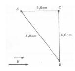
223. En la figura dada, el campo eléctrico uniforme vale 100V/m. Con los datos dados podrás deducir que la diferencia de potencial entre A y B, será el voltios de: c)3
