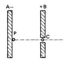
231. La diferencia de potencial entre las placas A y B, es de 1000V. Un electrón en reposo parte de P, y cruza hasta llegar a C, a través de un orificio en la B. Teniendo en cuenta la carga del electrón (1,6.10<sup>-19C</sup>), podrás asegurar que su energía cinética en electronvoltios es:
